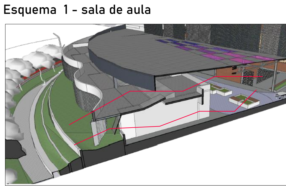
Esquema 1 - sala de aula As salas de aulas possuem tanto iluminação zenital, como também lateral, gerando ambiente com boa iluminação natural e boa circulação de ar.
